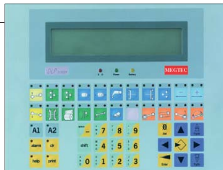
Pupitre opérateur pour le réglage du dérouleur, avec écrans d'état, de localisation de pannes, de diagnostic de maintenance et d'aide.
